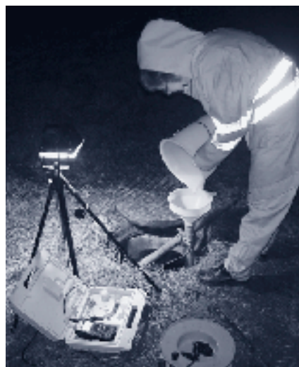
Exfiltrationsexperiment: Zugabe der NaCl-Lösung als Referenzsignal.
